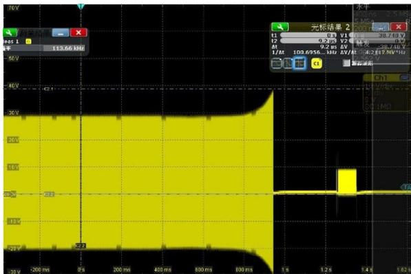
如上面波形，在极限偏移的条件下拿开 RX 时，TX 线圈最大  $V_{Coil\_PEAK}$  值增大，并触发了软件保护。
